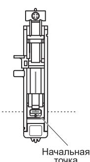
**3** Положите ткань под лапку так, чтобы игла находилась на расстоянии 2 мм от места, с которого необходимо начать выполнение закрепки, затем опустите рычаг лапки.
