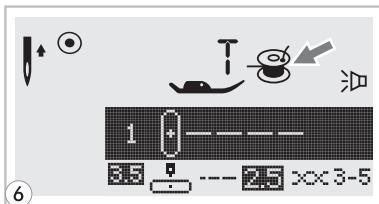
**6** Когда ограничитель шпульки сдвинут влево, на дисплее высвечивается анимация намотки шпульки "繞".
