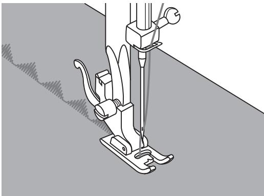
Установите лапку для декоративных строчек. На подошве лапки имеется небольшое углубление, которое позволяет выполнять строчки с большой плотностью стежков. Через прозрачную платформу лапки хорошо видна прошиваемая строчка.
