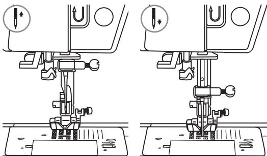
При остановке машины игла автоматически поднимается в верхнее положение. С помощью данной кнопки выбирается позиция иглы после окончания работы вверх/вниз, т.е. игла может подниматься в крайнее верхнее положение или оставаться в ткани.
