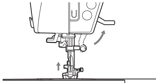
Рычаг подъема лапки опускает или поднимает лапку.
