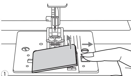
**1** Снимите прозрачную платформу и достаньте шпульку из челночной вставки.
