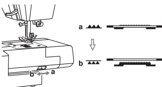
При сдвиге рычага в позицию "▲▲▲" (b) нижний транспортер опустится вниз, например, используется для пришивания пуговиц.
