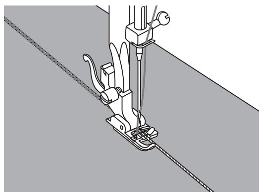
Установите лапку для вшивания шнуря. Наметьте на ткани место для прокладывания шнуря. Вставьте шнур в центральную канавку лапки. Вытяните шнур на 5 см.
