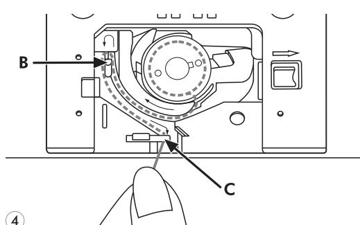
**4** Вытяните нить примерно по направлению от (B) к (C). Чтобы обрезать лишнюю нить, потяните ее в обратную сторону до лезвия (C). Затем закройте крышку игольной пластины.
