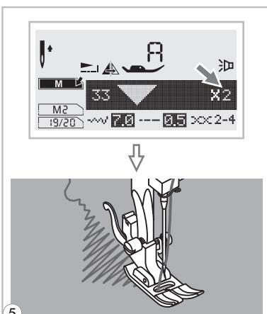
**5** В процессе работы машины, курсор на дисплее начнет двигаться по образцам строчек, показывая какой фрагмент прошивает машина.
