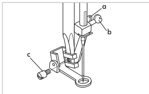
Снимите лапкодержатель и установите лапку для вышивки и штопки на стержень для держателя лапок. Рычаг лапки (а) должен лечь на винт иглы (б).
