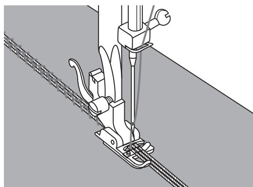
Наметьте на ткани место для прокладывания шнуря. Вставьте шнур в центральную канавку лапки. Вытяните шнур на 5 см.
