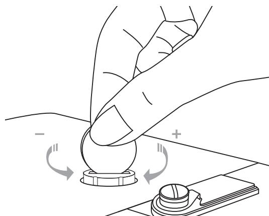
Давление лапки на ткань уже изначально настроено на оптимальную величину и не требует дополнительной регулировки (для легких и средних тканей).
