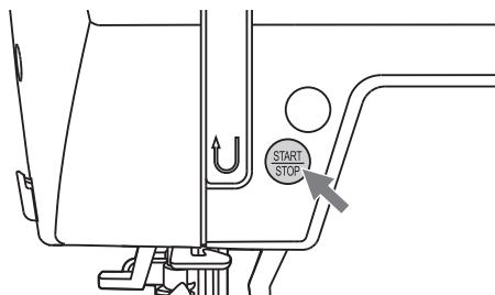
При нажатии на кнопку Старт/Стоп машина начинает шить, при повторном нажатии-останавливается. В начале шитья машина шьет на маленьких оборотах.
