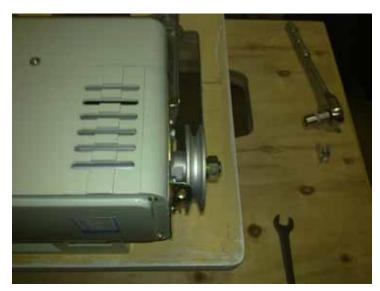
Выравниваем шкив двигателя по прорези деревянного поддона
