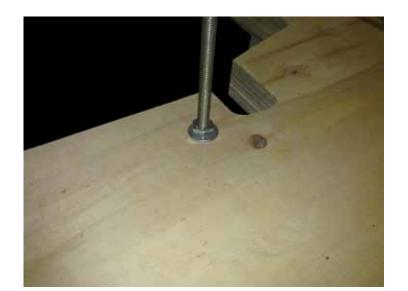
Крепим шпильки гайками
