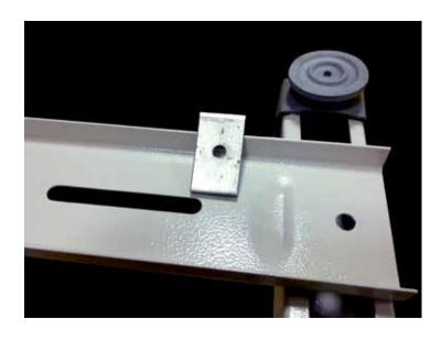
Крепим планку с помощью болта и прямоугольной пластины с резьбой, которую заводим снизу
