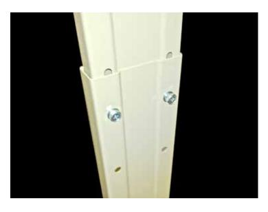
Заводим планку внутрь ноги, крепим её двумя болтами и выравниваем по высоте
