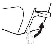
2. Поверните маховое колесо на себя (против часовой стрелки) и поднимите иглу в крайнее верхнее положение.
