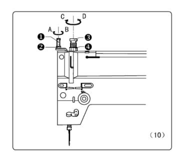
Как показано на Рис. (11): Как показано на рисунке (11): Чтобы отрегулировать длину стежка, поверните регулятор длины стежка (1). При повороте в направлении А длина стежка уменьшается. При повороте в направлении В длина стежка увеличивается.
