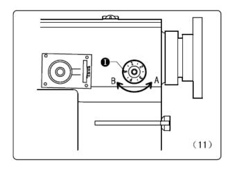
Регулировка размаха Как показано на Рис. (13): Макрорегулировка Индикатор размаха (2) показывает величину размаха в мм. Поверните регулятор (1), чтобы отрегулировать ее. При повороте в направлении А величина размаха уменьшается. При повороте в направлении В величина размаха увеличивается. Микрорегулировка Снимите резиновую заглушку (3), вставьте отвертку, чтобы повернуть эксцентрик (4) и отрегулировать размах
