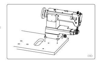
Как показано на Рис. 2: При помощи винта (2) прикрепите часть кожуха ремня (1) к крышке машины При помощи винта (4) скрепите часть кожуха ремня (3) с частью (1). При помощи винта (6) прикрепите часть
